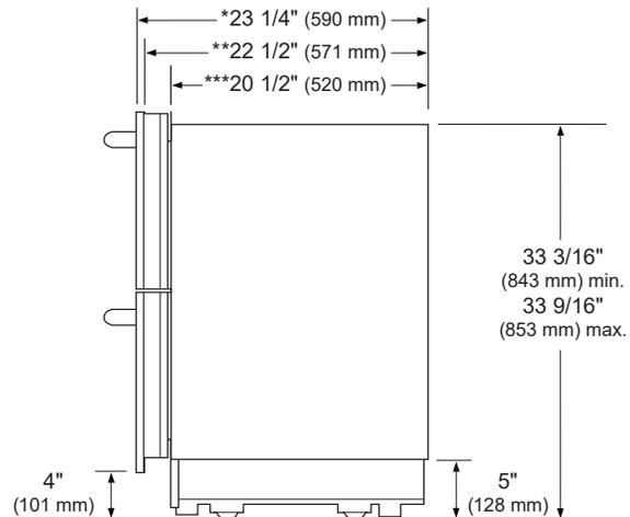
\* Profondeur avec des panneaux de 3/4 po (19 mm)
