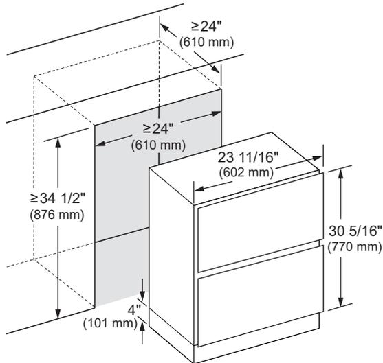
\* Une longueur finie d'un minimum de 4" (101 mm) sur la paroi intérieure de l'ouverture de la même couleur que la finition extérieure est recommandée sur chaque côté. La zone grisée sera visible après l'installation.
